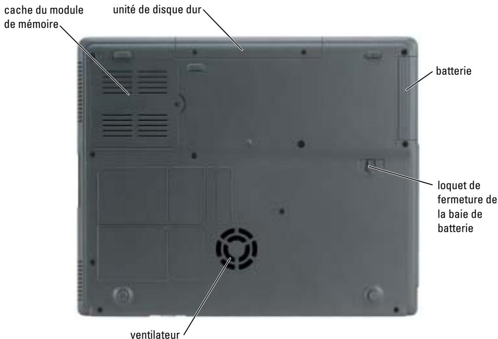
**CACHE DU MODULE DE MÉMOIRE** — Recouvre le compartiment du ou des module(s) de mémoire.
