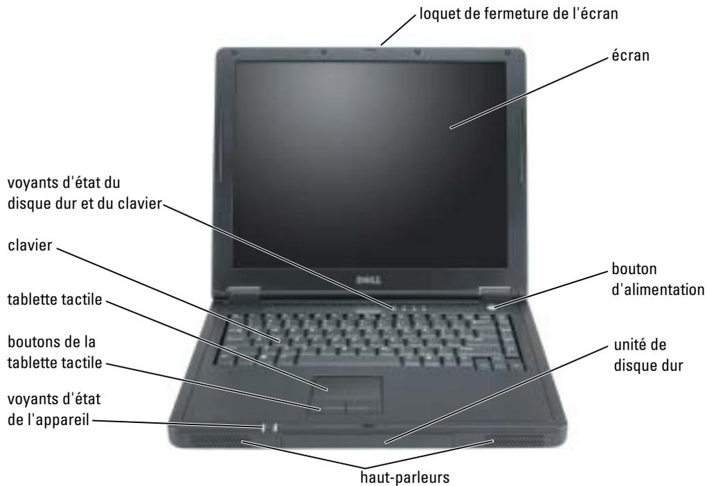
**LOQUET DE FERMETURE DE L'ÉCRAN** — Appuyez sur ce bouton pour dégager le loquet de fermeture de l'écran et ouvrir ce dernier.
